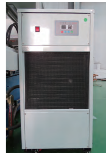
油温控制系统 Hydraulic system
